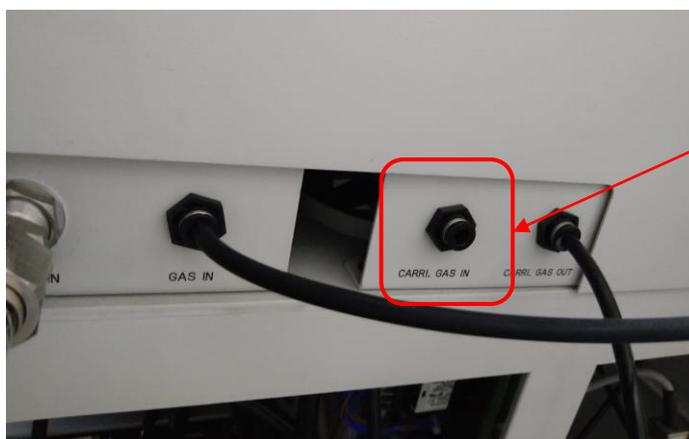
他のキャリアガス（雰囲気ガス）のタッチチューブを接続
