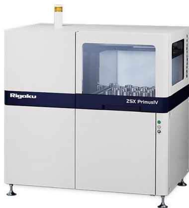
▲波長分散型蛍光X線分析装置 「ZSX Primus IV」
