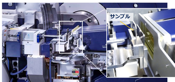
図4. 透過2D-WAXS光学系(カメラ長27 mm)の概要.
