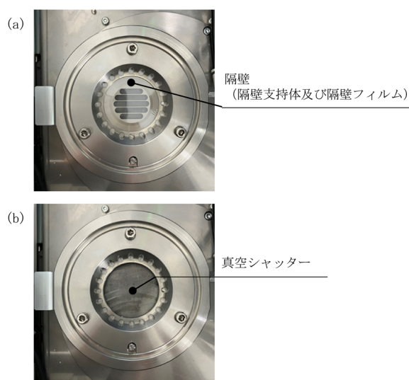
図2. 上から見た試料室内, (a) 大気/真空雰囲気測定適用時, (b) 真空またはヘリウム雰囲気測定適用時。
