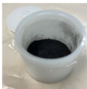
試料量：4 g 試料容器：3399N095 試料フィルム：プロレン 4 \mu m
