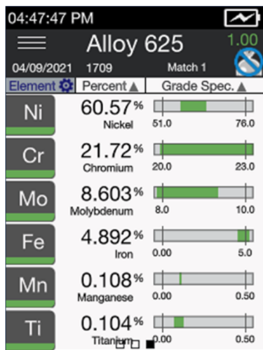
図3. ニッケルベース耐熱合金 Alloy 625 の分析例.
