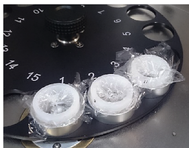
図6. 液体試料測定時の様子 (NEX CG).
