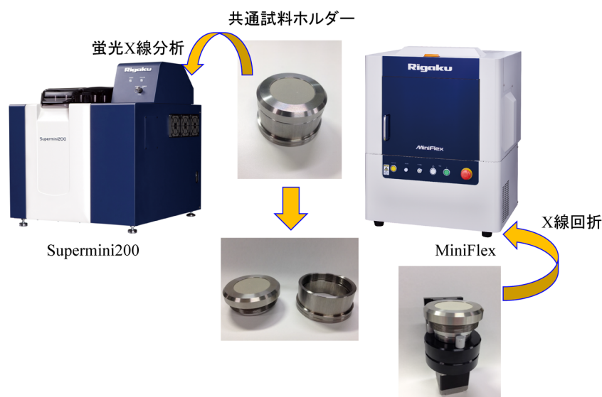
図11. デスクトップX線回折装置MiniFlexと波長分散小型蛍光X線分析装置Supermini200用共通試料ホルダー。
