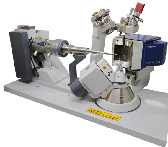
図4. XtaLAB Synergy-DWシステム。 湾曲型HPC検出器HyPix-Arc150°との組み合わせ例。
