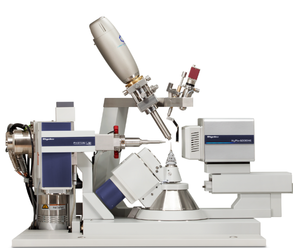
図3. 回転対陰極型X線発生装置を備えたXtaLAB Synergy-Rシステム。
