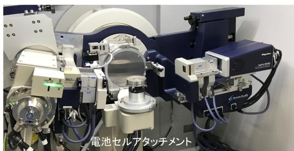
図2. SmartLabの反射配置 (検出器 HyPix-3000).
