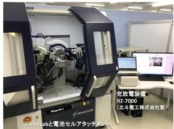
図7. X線回折装置SmartLabと充放電装置HZ-7000の電池評価システム.
