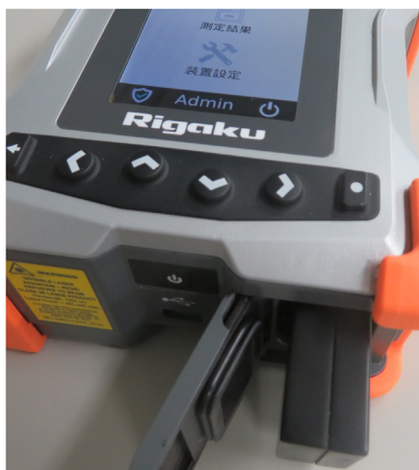
図13. 通電のままのバッテリー交換.
