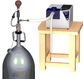
(2) LN 2 サイフォン冷却ユニット
