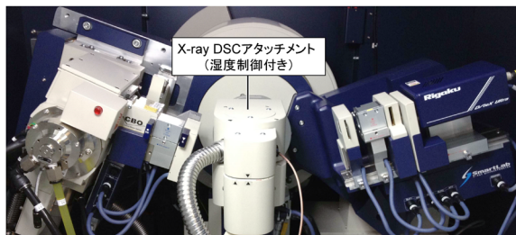
図2. X-ray DSCアタッチメントを取り付けた粉末X線回折装置。
