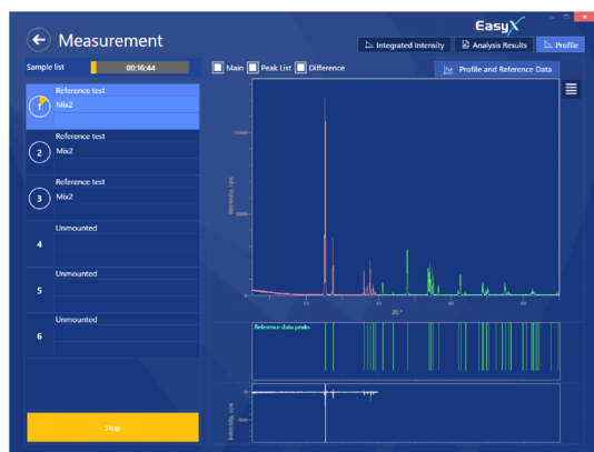
図1. 参照パターンとの自動照合画面。 測定画面において赤線が実測パターン、緑線が参照パターン、画面下に両者の差分を示す。
