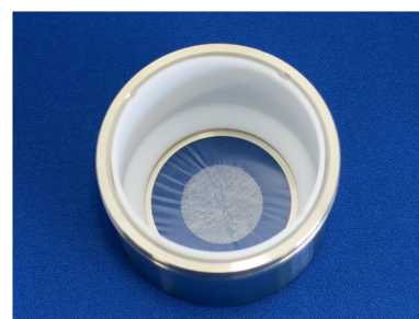
図8. 試料ホルダーにフッ素樹脂製試料押さえを使用し試料をセット.
