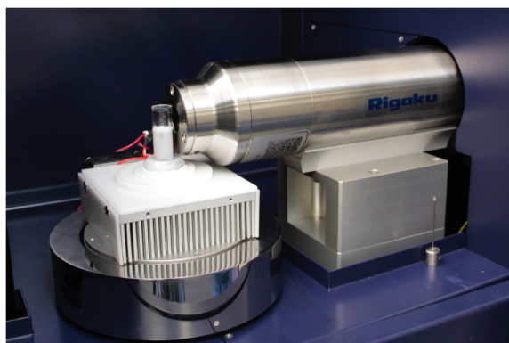
図2. ペルチェ素子を採用して、 -20^{\circ}\text{C} までの低温試験が可能。上部の透明プラスチック内に試料を配置する。
