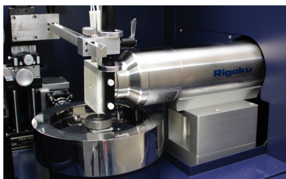
図3. 非接触型の高温試験器。試料は、通常測定時と同様にセットし、上からヒーターを内蔵した温調ブロックを降ろし、試料を覆う。X線の透過位置には常に窓があり、試料回転位置に関係なくX線像を取得することができる。
