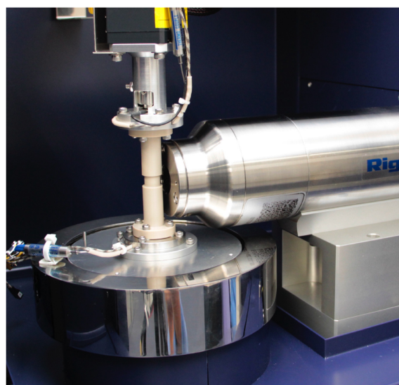
図1. nano3DXに高温・圧縮試験器を取り付けたところ。上部にあるモーターで、圧力を印加する。外壁は耐熱プラスチック製で、200 Nの圧縮時にも、200℃までの高温測定が可能である。
