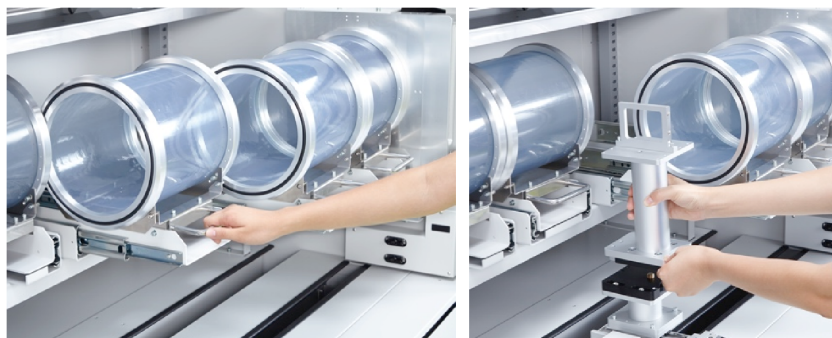
図4. 真空パス換装機構 (左) および試料ステージ (右).
