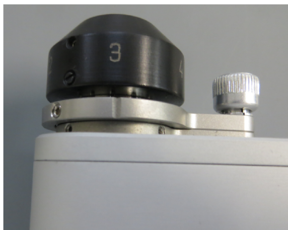
図2. 先端位置設定可能ノーズコーン。
