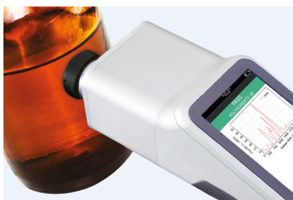
図3. 瓶の外からの測定。
