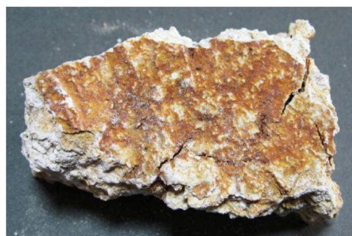
図5. 高松塚古墳石室目地漆喰表面の破片.
