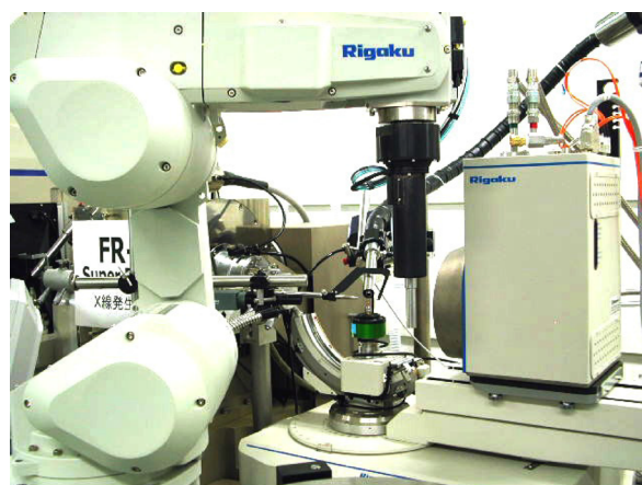
図6. ハイスループット単結晶X線構造解析用システム。試料交換ロボットと結晶の自動センタリング・評価機能が備わっている。評価の高い順に測定する、評価の低い結晶については測定しないなどの選択が可能。
