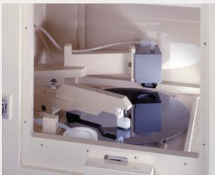
回収液ノズルの形状は、リガク独自の工夫で、液滴を逃すことはありません。また、回収後ノズルは自動洗浄し、次の処理に備えます。
