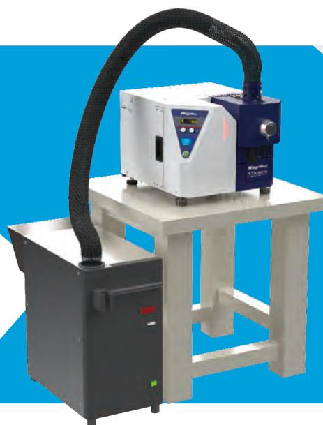
CO<sub>2</sub>などのガスを用いた吸着材の評価においては、温度が低いほど吸着量が増加する傾向があるため、室温以下での測定が求められる場合があります。STAvesta/LRはこれに対応し、-40°Cからの低温評価を可能にします。これにより、室温では吸着しにくいガスの特性把握が可能となり、吸着材の性能をより正確に評価することができます。
