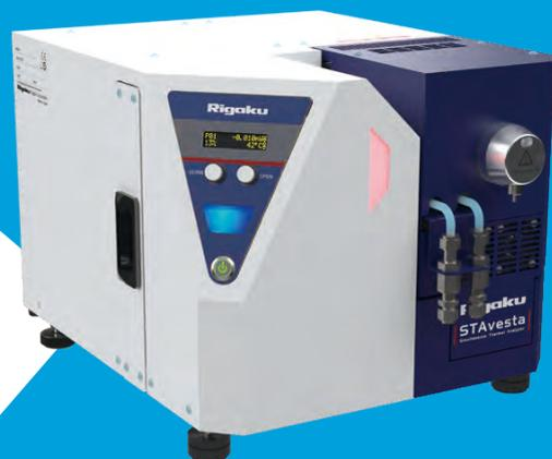
赤外線を集光し試料を加熱します。電気炉自体の熱容量が小さいので700℃まで120秒（ステップ加熱）と高速での昇温が可能となり、高温での温度ホールドにも優れています。最高950℃までの測定が可能です。
