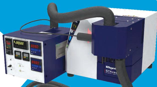
STAvesta/HUMは示差熱天秤と水蒸気発生装置を組み合わせ水蒸気雰囲気中でTG-DSC測定を行う装置です。湿度センサーには高分子型相対湿度センサーと高精度温度センサーを採用し、レスポンスの良い水蒸気濃度制御と長時間の安定性を実現しました。ASC対応。
