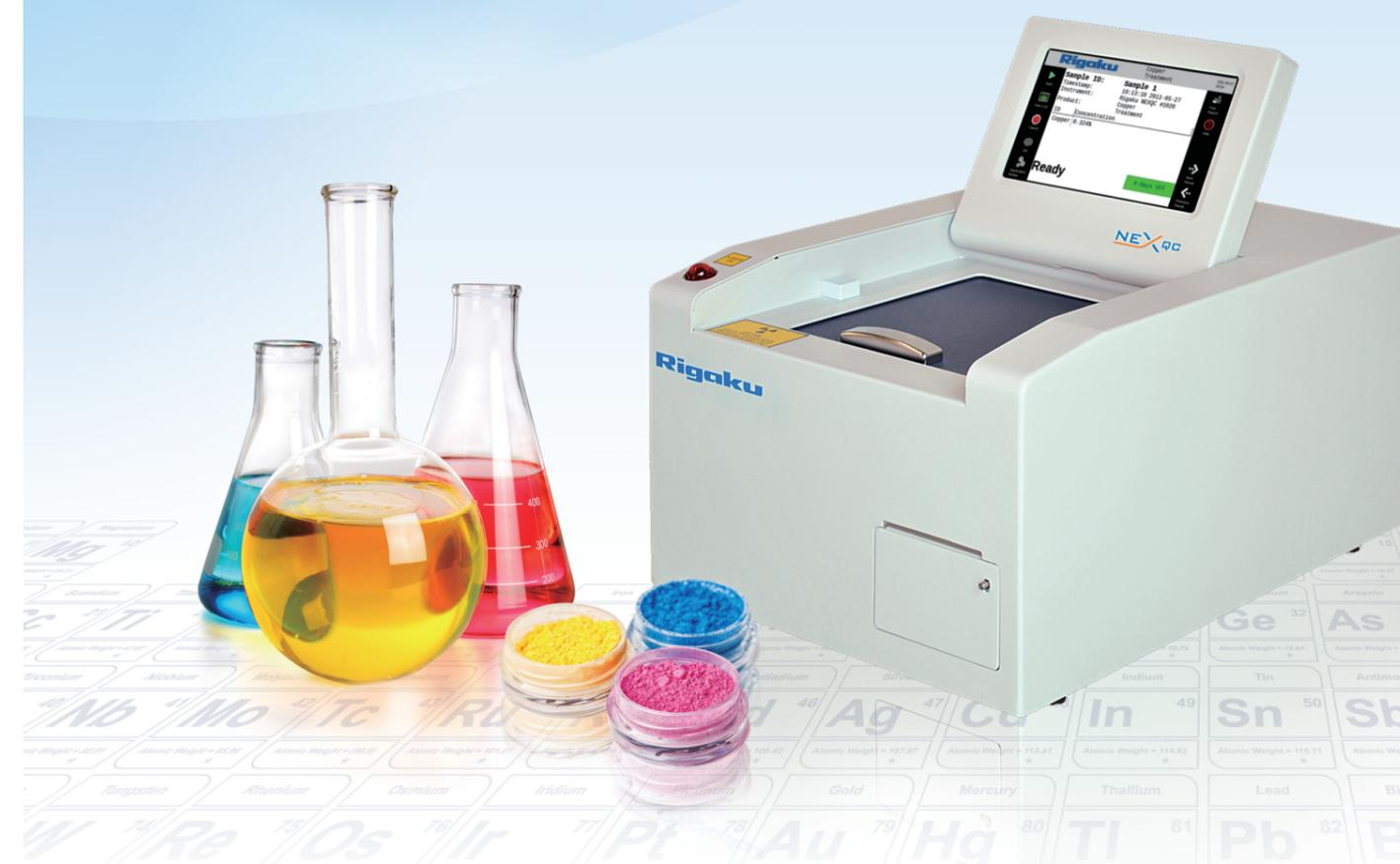
固体、液体、粉末、合金などナトリウムからウランまでを非破壊分析
