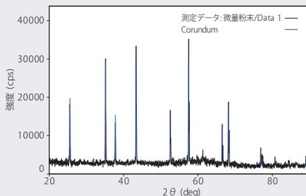
微量 Al<sub>2</sub>O<sub>3</sub> 粉末 (0.2 mg) のX線回折パターン
