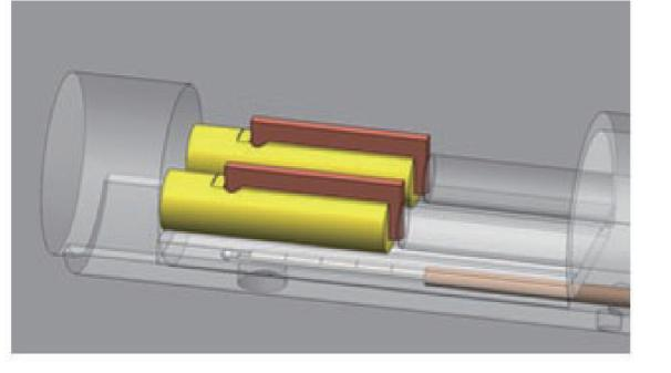
薄い試料や小さい試料、強度が弱い試料なども 試料に応じた搬送ボートを使うことで ASC 測定が可能になります。
